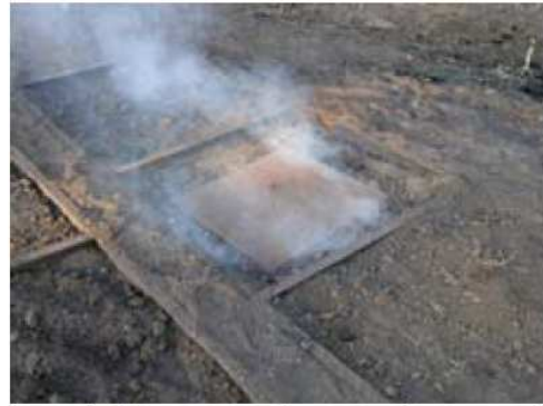
Cierre del horno en la zona de encendido
