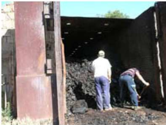
Descarga del horno en el interior
