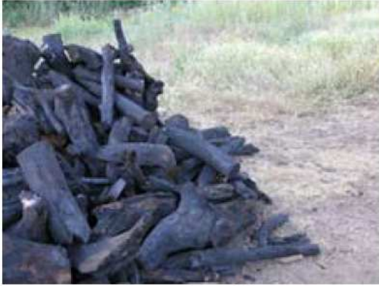
Tizos extraídos del interior del horno
