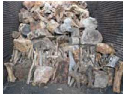
Colocación de leña gruesa en la parte inferior y superior
